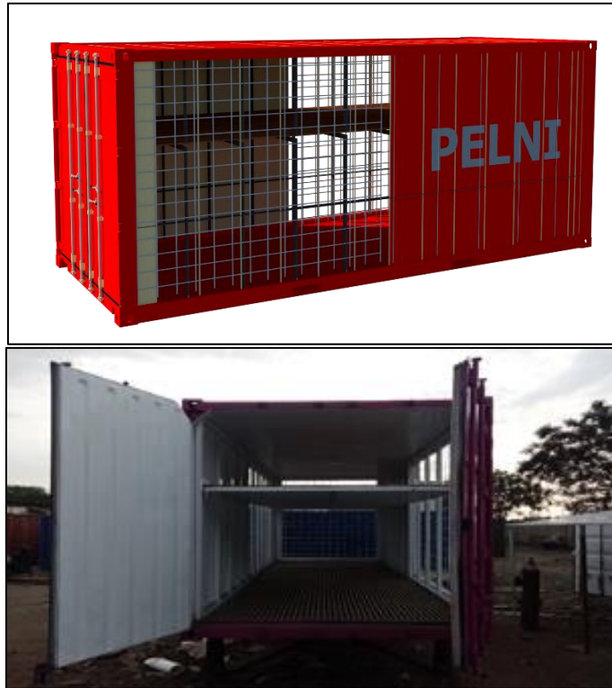
Gambar 6. Desain 3D (kiri) dan prototipe (kanan) kontainer pengangkut LPG 12 kg (Analisis, 2021)
