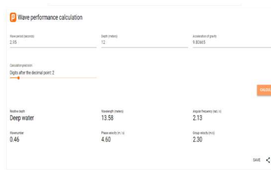
Gambar 5. Karakteristik Gelombang di Perairan Sausapor Berdasarkan Aplikasi Wave Performance Calculation
